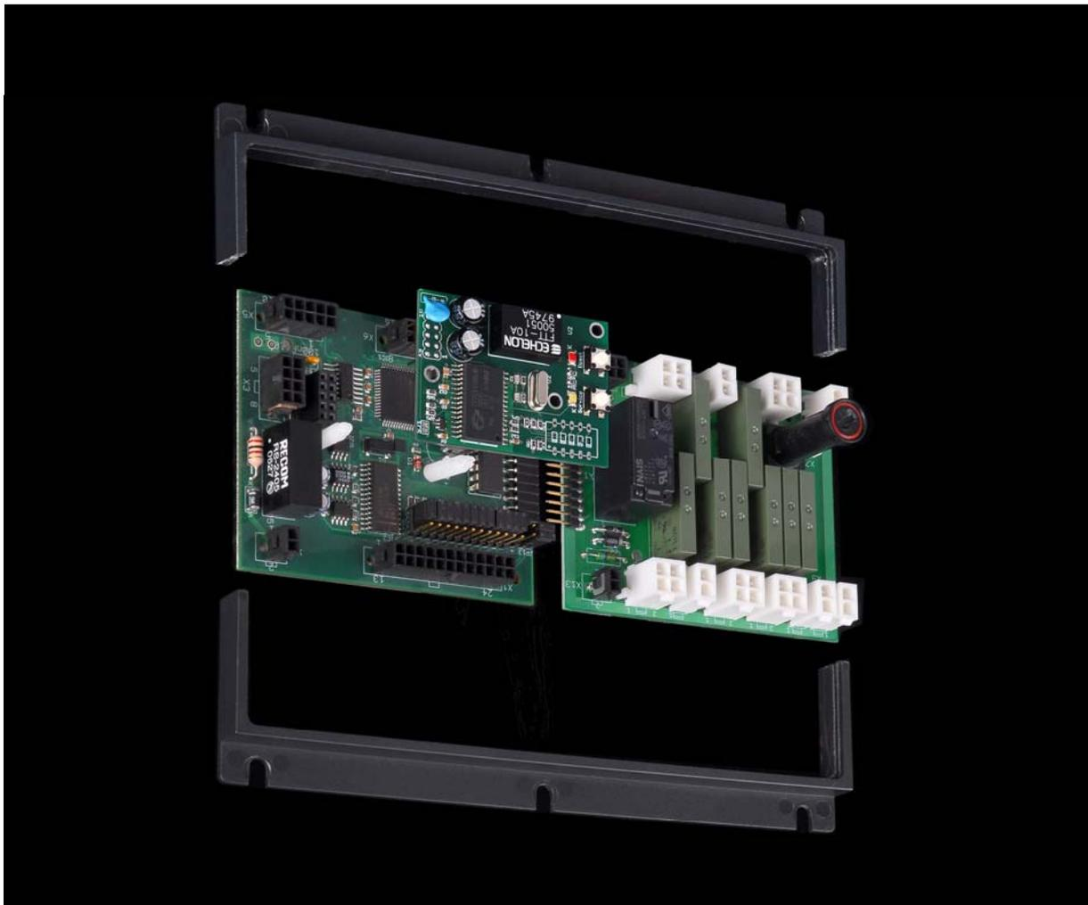
Abbildung 6: Reglerplatine WPCU.C und Relaisplatine WPCU.R
